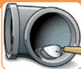
**Nota:** Miscelare piccole quantità alla volta per evitare una rapida polimerizzazione
