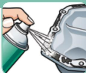
**Nota:** Prima di applicare una nuova guarnizione liquida, pulire la superficie con Loctite® 7063 o Loctite® 7070.
