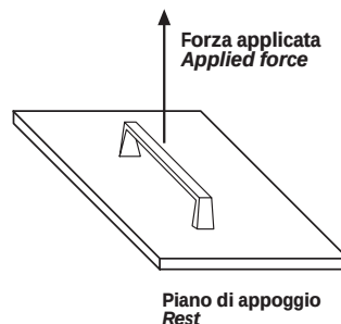
SCHEMA DI PROVA PER CARICO A TRAZIONE DI ROTTURA DIAGRAM OF TENSILE STRENGTH TEST
