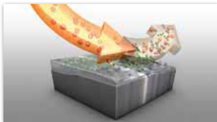
Sfere ceramiche piccole portate via da particelle grosse
