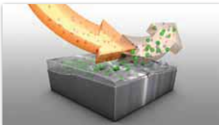
Sfere ceramiche grandi scavate da particelle fini
